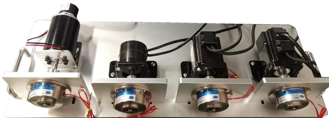
图10 多电机对拖台
